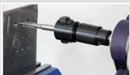
Механизъм за механично реверсиране след нарязване на резбата
