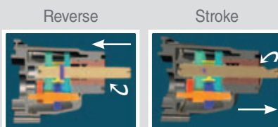
Механизъм за механично реверсиране след нарязване на резбата
