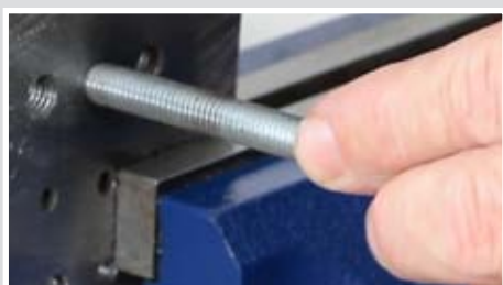
Самонагаждащ се двучелюстен патронник, който компенсира позицията на шпиндела спрямо отвора на резбата.
